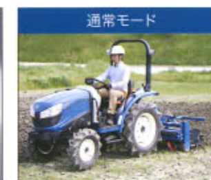
設定した耕うん深さにあわせて自動制御します。
