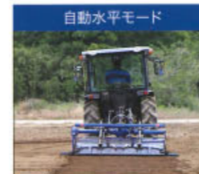
機体が傾いても、作業機は水平を保ちます。
